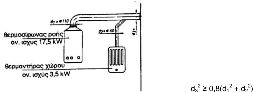
**Εικόνα 9.2** Σύνδεση με κοινό καπναγωγό θερμαντήρα νερού και θερμαντήρα χώρου
