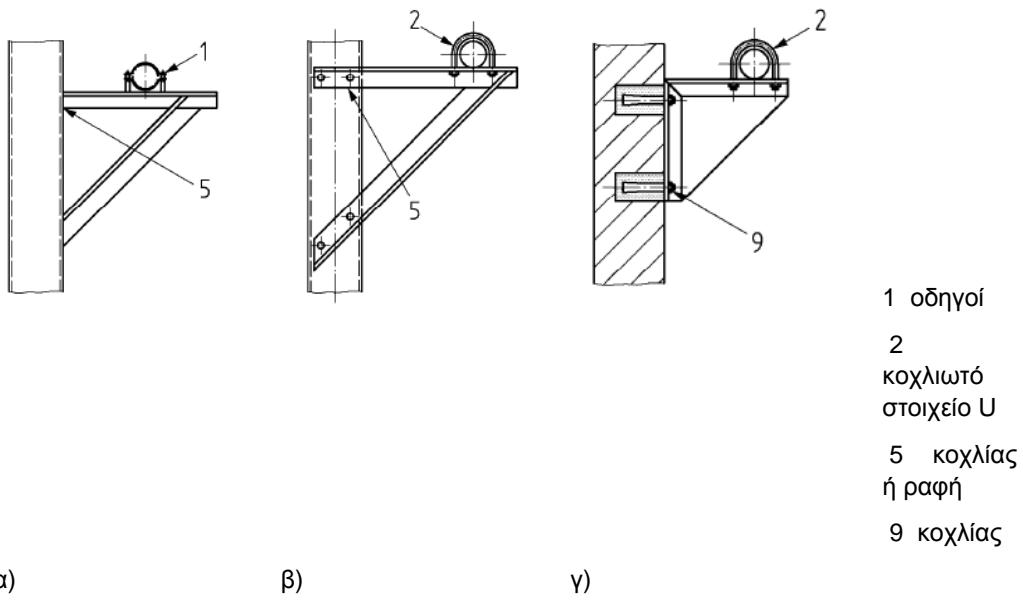
Εικόνα 1.10 Τυπικοί βραχίονες στήριξης σωλήνων
