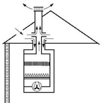
Οι συσκευές του τύπου C<sub>7</sub> δεν αντιμετωπίζονται στους κανόνες εγκατάστασης επειδή δεν αναμένεται χρήση τους λόγω κατασκευαστικών ιδιαιτεροτήτων
