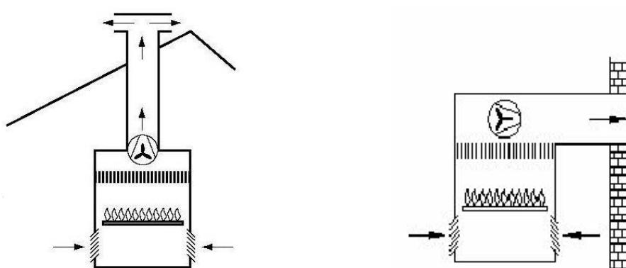
**B<sub>53</sub>** με ανεμιστήρα πριν τον καυστήρα
