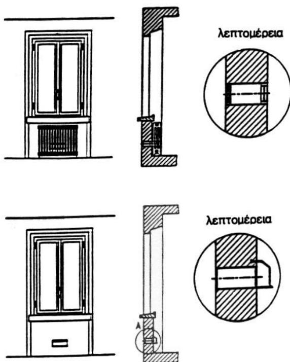
Εικόνα 8.3 Παραδείγματα θέσεων ανοιγμάτων τροφοδοσίας αέρα
