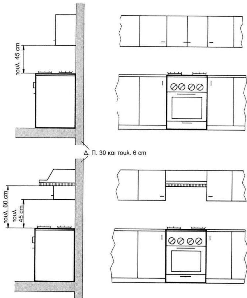
Εικόνα 8.2 Παράδειγμα εγκατάστασης μαγειρικών εστιών (ελεύθερη ή εντοιχισμένη)
