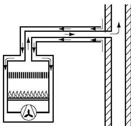
**3.4 Τύπος B<sub>4</sub>** Συσκευή αερίου με ασφάλεια ροής συνδεόμενη μέσω αγωγού σύνδεσης μόνο σε δικό της ατομικό αγωγό απαγωγής καυσαερίων
