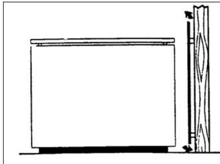
Εικόνα 8.1 Παράδειγμα για αεριζόμενη προστασία έναντι θερμικής ακτινοβολίας
