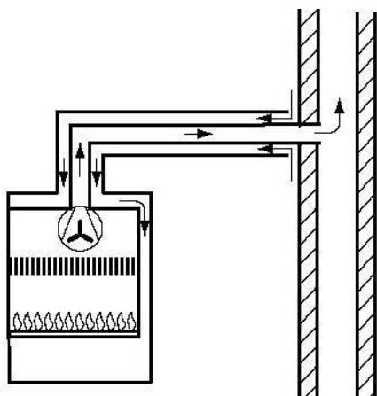
**B<sub>3</sub>** με ανεμιστήρα πριν τον καυστήρα
