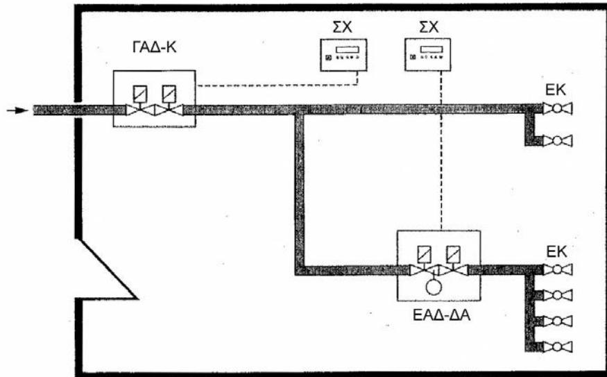
Εικόνα 1 Παράδειγμα δικτύου σωληνώσεων σε αίθουσα φυσικών και τεχνικών μαθημάτων
