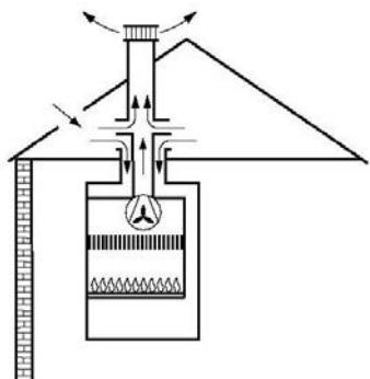
**C<sub>73</sub>** με ανεμιστήρα πριν τον καυστήρα
