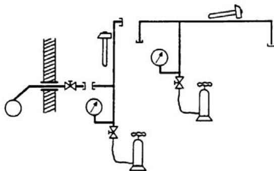
**Εικόνα 10.1 Δοκιμή αντοχής**
