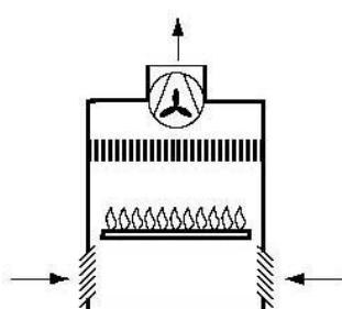
**B<sub>23</sub>** με ανεμιστήρα πριν τον καυστήρα
