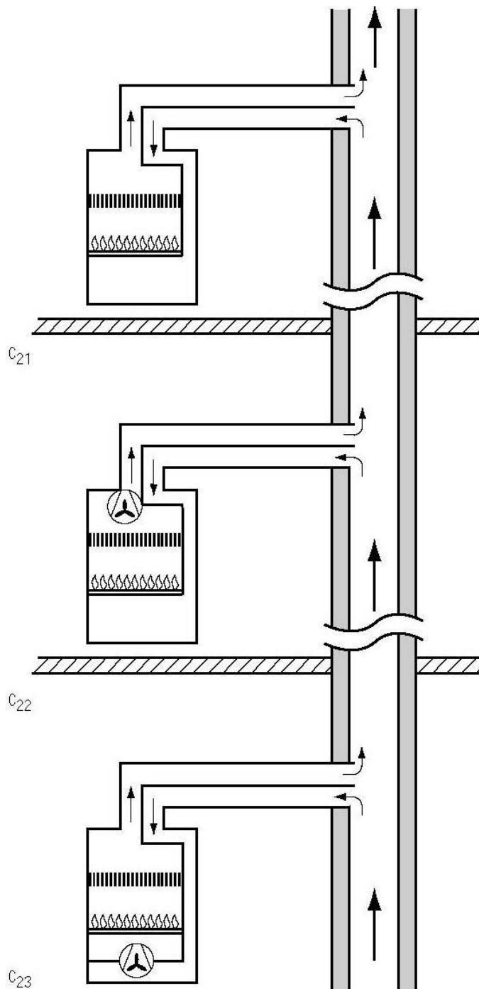
'Οσον αφορά τον τύπο C<sub>21</sub> πρόκειται για υφιστάμενη συσκευή. Όμως οι συσκευές του τύπου C<sub>2</sub> δεν αντιμετωπίζονται στους κανόνες εγκατάστασης (επειδή δεν αναμένεται χρήση τους, καθ' ότι απαιτούν την ύπαρξη στο κτίριο ειδικών αγωγών, κοινών για αέρα και καυσαέρια,
